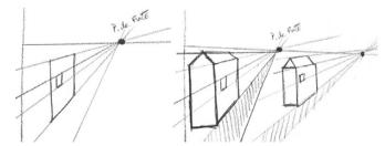
Les lignes de fuite sont surtout utilisées pour la perspective des bâtiments. Elles permettent de définir le haut et le bas d'une architecture et en donnent la direction selon le point de vue de l'observateur. Plus on décale le point de fuite, plus les lignes sont en biais.
